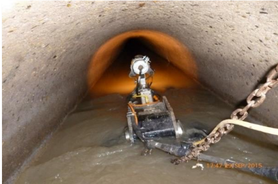
Inspection par caméra et sonar dans une canalisation en eau (source : Ventura 2017)
